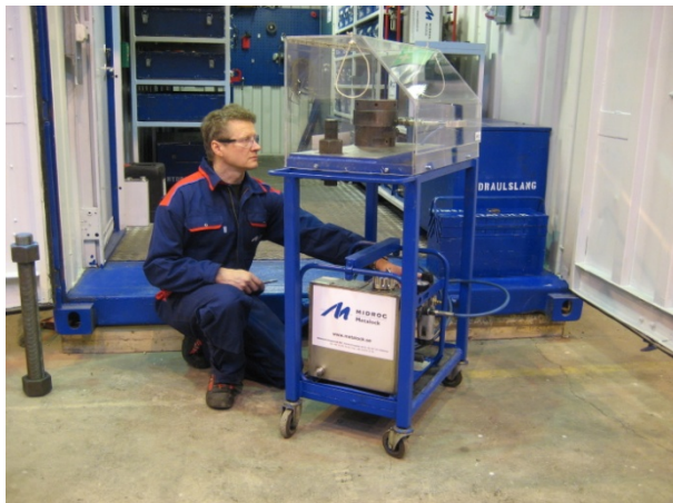
Provtryckning och läckagetest i vår mobila tryckbänk
